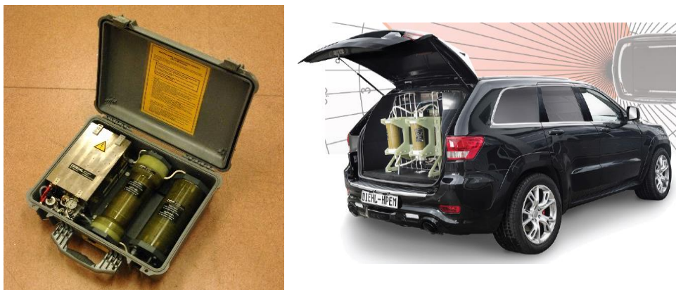
Figur 13. Två olika typer av bredbandiga HPM-vapen framtagna av Tyska Diehl Defence. Till vänster en kommersiellt tillgänglig utrustning som får plats i en resväska av kabintyp och till höger en utrustning framtagen för att stoppa bilar på upp till 15 m. Foto: FOI och Diehl Defence.
