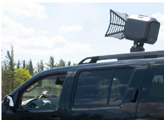
Figur 14. Utrustning designad för att störa ut små drönare av quadrokoptertyp. Enheten är batteridrivnen och allt som behövs finns i burken som sitter monterad på biltaket. Foto: Diehl Defence.
