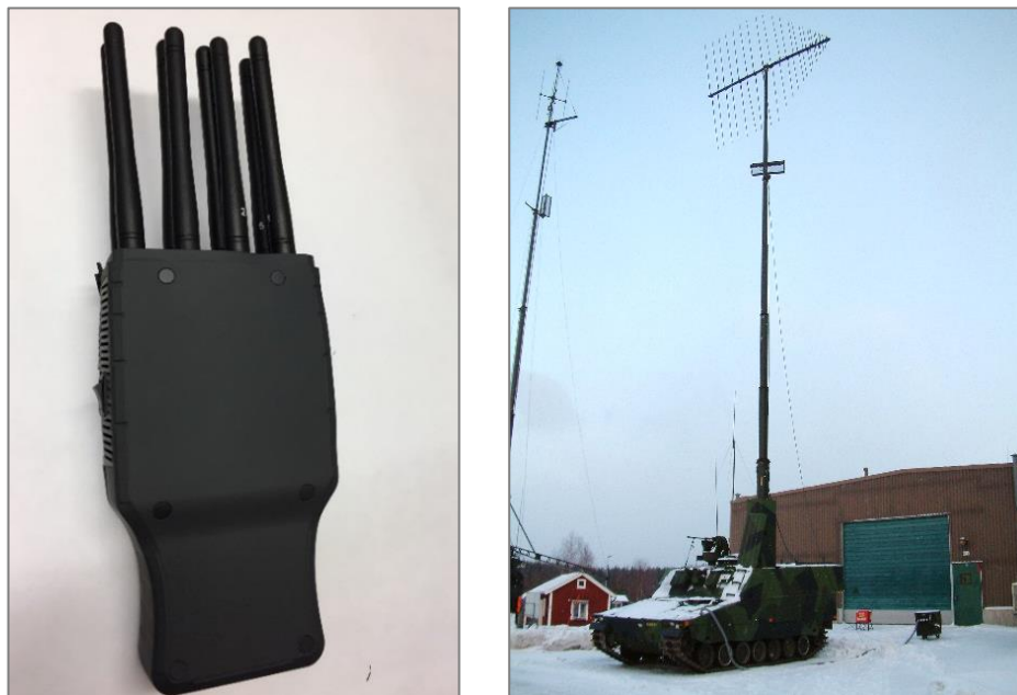
Figur 11. Olika typer av störsändare. Till vänster: en kommersiellt tillgänglig störsändare kapabel att störa flera kommersiella kommunikationssystem och GPS. Till höger: militär störsändare. Foto: FOI och FOI/FM.
