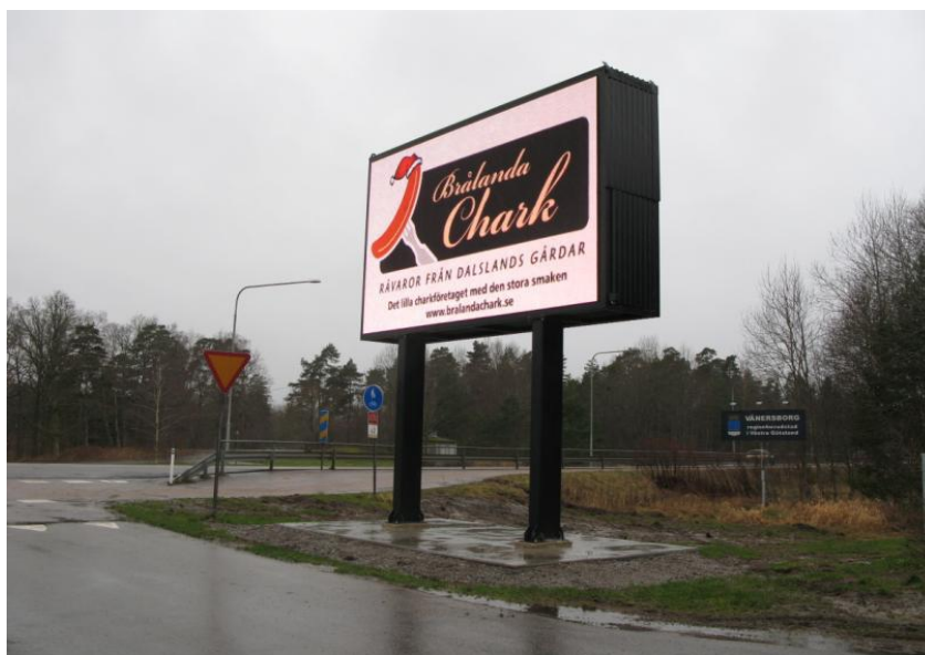
Figur 6. Reklamskylt som störde ut flygledning på Trollhättan-Vänersborgs flygplats [11] Foto: Henrik Olsson, Elsäkerhetsverket.
