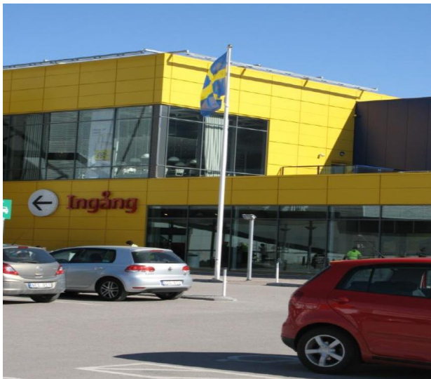
Figur 7. Flaggbelysning vid shoppingcenters entré som störde ut en basstation för GSM-nätet [12] Foto: Henrik Olsson, Elsäkerhetsverket.
